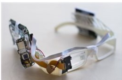
Πρότυπος σκελετός Google Glass όπου αποκαλύπτεται το εσωτερικό του και η διασύνδεση (Google Glass Basecamp, Chelsea Market, Παρασκευή 24 Ιανουαρίου, 2014, Νέα Υόρκη)
